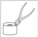
Muffeln nach dem Guss/Pressen an einem geschützten und gekennzeichneten Platz an der Luft auf Handwärme abkühlen lassen, **nicht in Wasser abschrecken!** Einbettmassen enthalten Quarz. Staub nicht einatmen! Gefahr von Lungenschäden (Silikose, Lungenkrebs). Um Staub beim Ausbetten zu vermeiden, die nach dem Guss völlig ausgekühlte Muffel in Wasser legen, bis sie durchfeuchtet ist.
